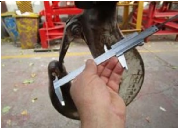
Equipo de medición (Pie de Metro) para medición de nivel de desgaste del gancho.
