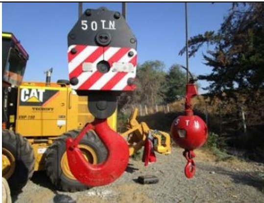
Ganchos de la carga directa la cual trabaja de manera directa con la vertical
